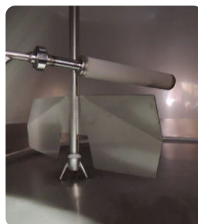
Fritté d'aération et pale d'agitation
