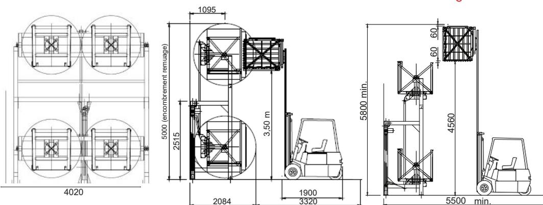
Cage à porte inf. et Cage ouverte sup. mm
