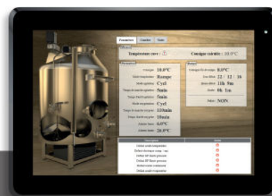
Écran tactile Fonction abaissement automatique de température / Suivi des sondes courbes / possibilité de supervision / connexion internet / suivi à distance
